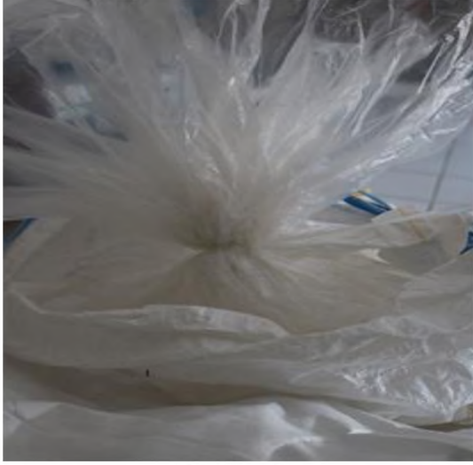
Resim 11 İç Naylonun Kablo Bağı ile Bağlanması
