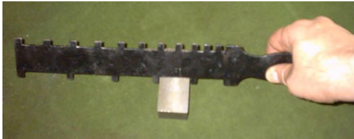
Resim : Kalınlık kontrol mastarı ile kalınlık kontrolü
