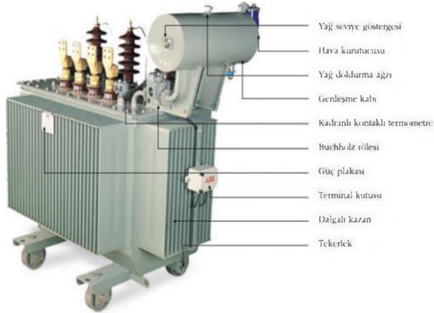
Şekil: Genleşme Depolu Transformatör
