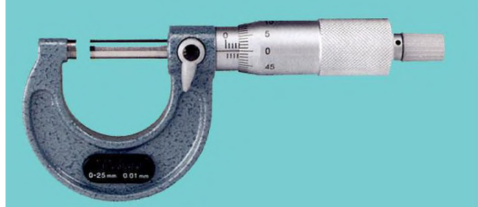
Resim: 0-25 mm Aralığında 0,01 mm hassasiyetinde mikrometre
