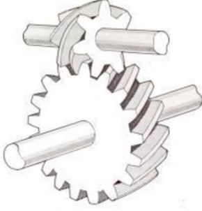
Şekil 2.a: Mil eksenleri ayrı düzlemlerde olan helisel dişli çarklar
