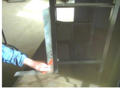
Resim: Taşçı gönyesi ile parçanın dikliğinin kontrol edilmesi
